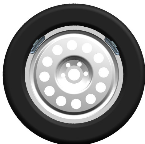
DOS PESOS DE MENOR ENTIDAD (55 g) (1.94 oz) USANDO EL PROCEDIMIENTO SPLIT
