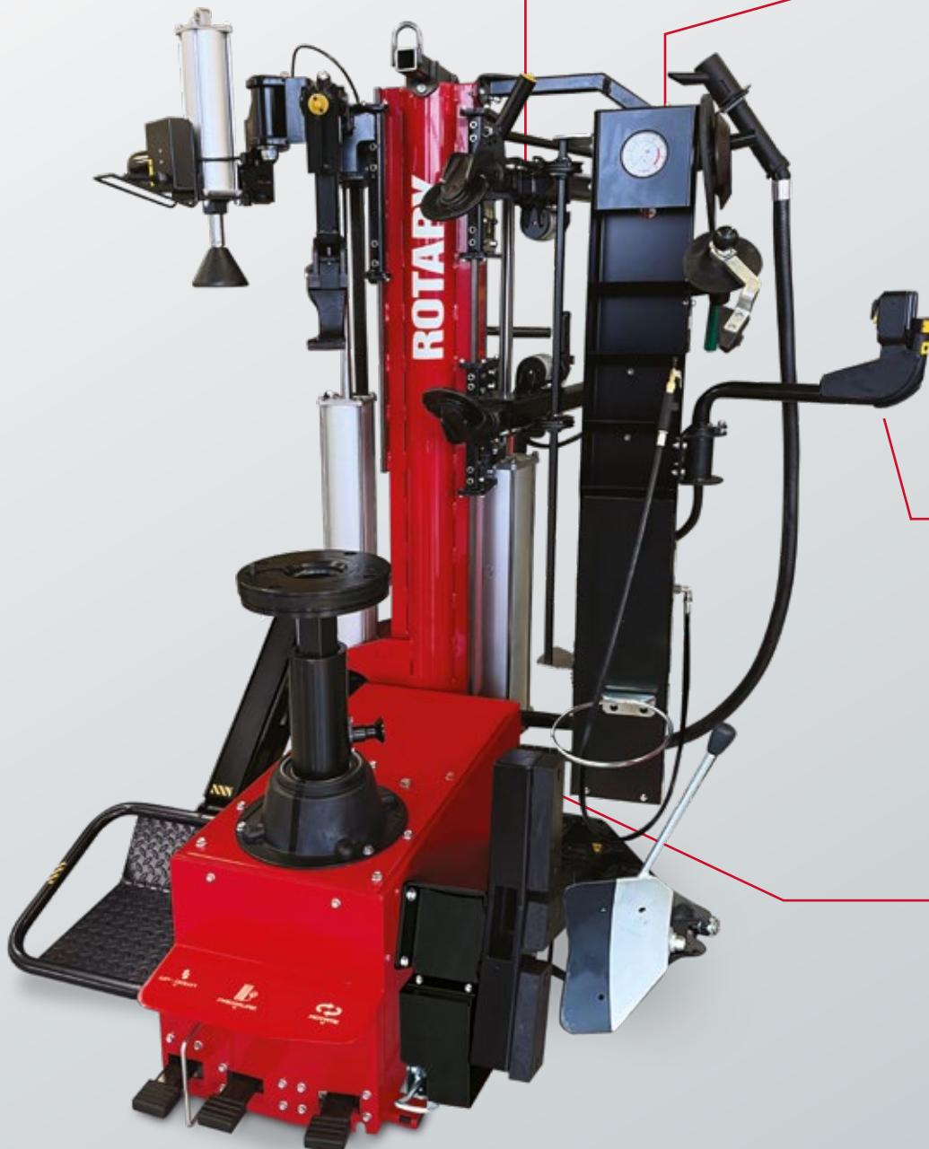
Mouvement des bras synchronisé par un **SYSTÈME DE POULIES ET DE CÂBLES**
