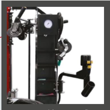
Zone porte-objets et gonflages des pneumatiques placés à une hauteur ergonomique.
