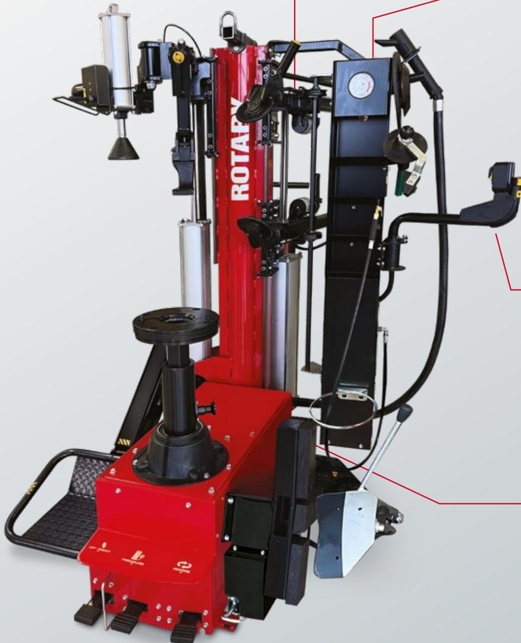
Movimiento de los brazos sincronizado mediante un **SISTEMA DE POLEAS Y CABLES** que garantiza un diseño compacto, optimizando el espacio de trabajo.
