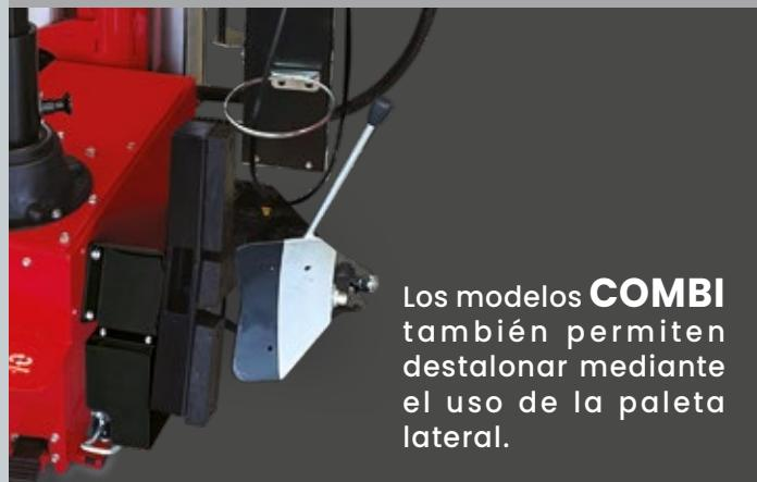
Los modelos **COMBI** también permiten destalonar mediante el uso de la paleta lateral.
