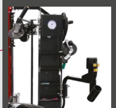
Zona para depositar objetos y sistema de inflado de neumáticos ubicados a una altura ergonómica.
