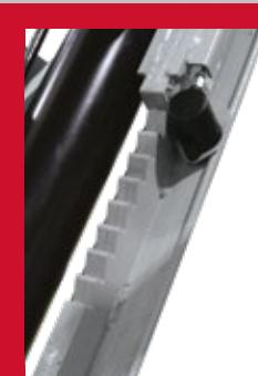
**МЕХАНИЧЕСКОЕ УСТРОЙСТВО БЕЗОПАСНОСТИ С АВТОМАТИЧЕСКИМ ВКЛЮЧЕНИЕМ И ПНЕВМАТИЧЕСКИМ ОТКЛЮЧЕНИЕМ**, предотвращающее случайное опускание груза и гарантирующее максимальную безопасность при остановке.
