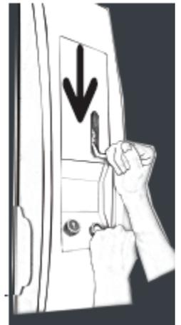
Der SICHERHEIT-ENTRIEGELUNGSGRIFF besitzt eine
