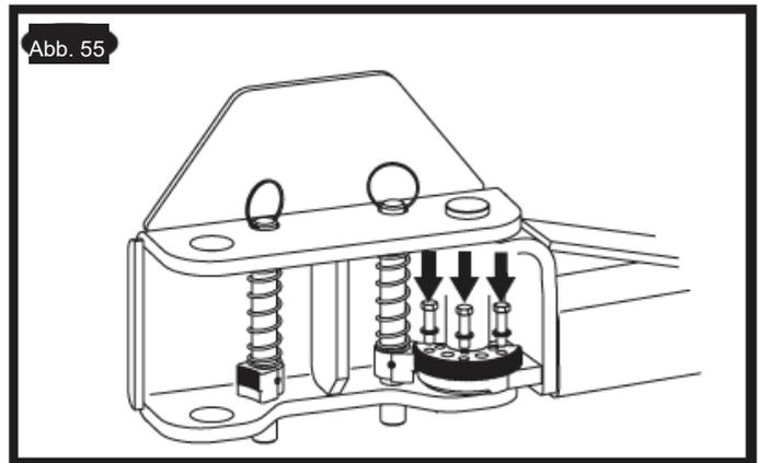
**i** Zum Überprüfen der Funktion der Armrückhaltungen den Schlitten 25 Min. lang aus der vollständig abgesenkten Position hochfahren.
