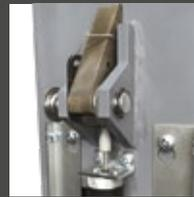
**FERMI DI SICUREZZA MECCANICI** integrati su entrambi i lati con azionamento automatico.
