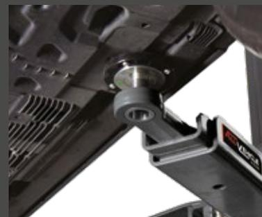
Per raggiungere **PICCOLI PUNTI DI PRESA SPECIFICI** su veicoli elettrici con lo spazio sufficiente per rimuovere le batterie di propulsione.
