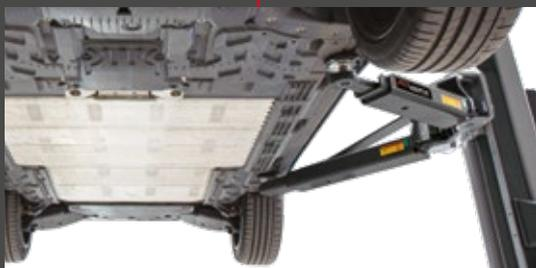
Le bras extérieur et le tampon ont la même hauteur, réduisant toute possibilité de contact du bras avec le dessous de caisse du véhicule.
