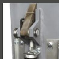
Los **PESTILLOS DE SEGURIDAD MECÁNICOS** están integrados en ambos lados e incorporan un sistema de accionamiento automático.
