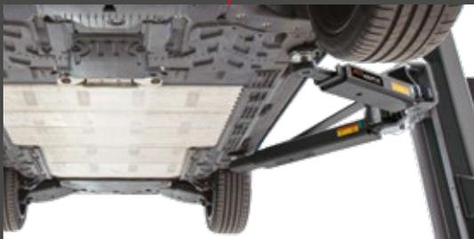
Der äußere Arm und der Adapter weisen das gleiche Höhenmaß auf, um die Möglichkeit einer Berührung des Arms mit dem Fahrzeugunterboden zu reduzieren.
