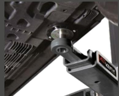
**SPEZIFISCHE AUFNAHMEPUNKTE AN ELEKTROFAHRZEUGEN** sind mit dem erforderlichen Freiraum zum Entfernen der Antriebsbatterien erreichbar.
