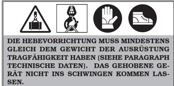
Wenn das Gerät von ihrer normalen Arbeitstellung zu einer anderen bewegt werden muss, so müssen die folgenden Anweisungen beim Transport der Maschine befolgt werden:
