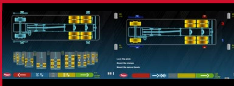
**Fahrzeuge mit mehreren Achsen** können einfach und schnell vermessen werden. Das Verfahren ist geführt und auch für weniger erfahrene Anwender einfach durchzuführen.
