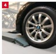
**1** Для размещения транспортных средств большого и малого размера подъемник XS30N / XS30N-CAT оснащается удлинителями платформы, которые устанавливаются по обеим сторонам и легко блокируются.
