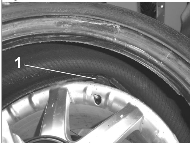
4. Ubicar la cabeza útil superior (**Fig. 56 ref. 1**) de manera que coincida con el borde de la llanta.
