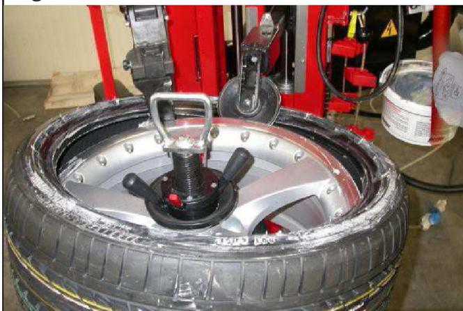
5. Posicionar el alargue presionatalón y el empuja-talones con guía en correspondencia con la válvula/sensor. Insertar las láminas de protección talón (Fig. 92) en la brida de la llanta y, en pequeña parte, también debajo del alargue presionatalón (Fig. 93) para evitar dañar el talón.
