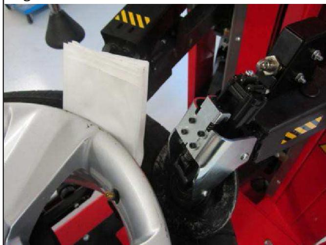
4. Presione el talón en el canal de la llanta utilizando el dispositivo presionatalón (**Fig. 78**) e inserte las cuñas (**Fig. 79 y Fig. 80**).
