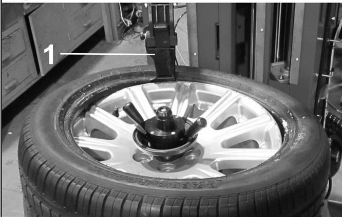
6. Montar el empujatalón con guía en el borde de la llanta (véase **Fig. 58**).
