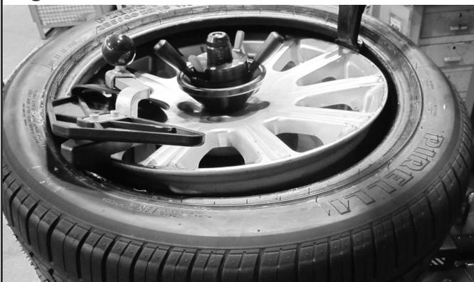
7. Bajar el rodillo destalonador superior afin de mantener el talón del neumático a la altura del centro de la llanta (véase **Fig. 59**).
