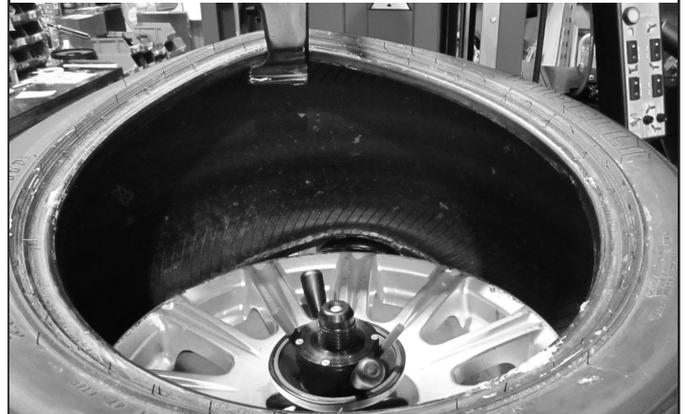
11. Por tanto, hacer avanzar el rodillo destalonador con el mando adecuado (**Fig. 17 ref. E**) de manera que se introduzca entre borde llanta y talón inferior (véase **Fig. 52**).
