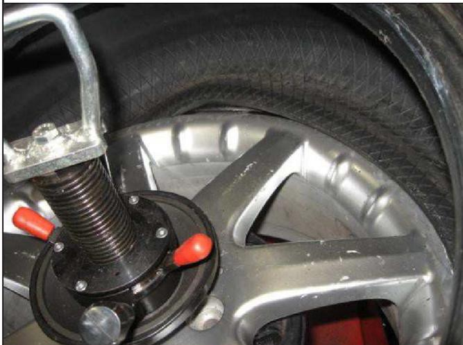
7. Presione el pedal de rotación y gire la rueda hasta que el neumático esté completamente extraído.
