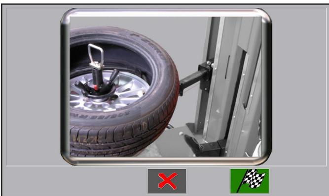
Al final de la fase anterior, el equipo posiciona la cabeza útil superior y el rodillo destalonador superior en posición de montaje del talón superior. La válvula se coloca delante del punto de inserción del conductor.
