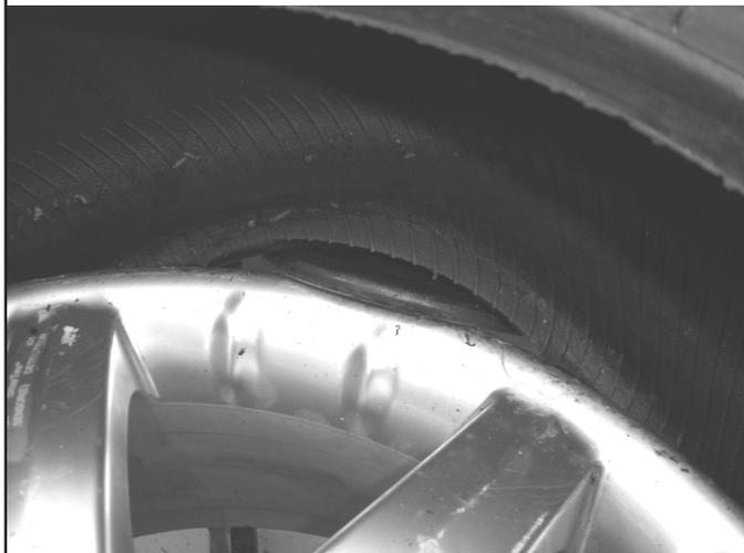
12. Por tanto, girar y completar el desmontaje del talón (véase **Fig. 53**).
