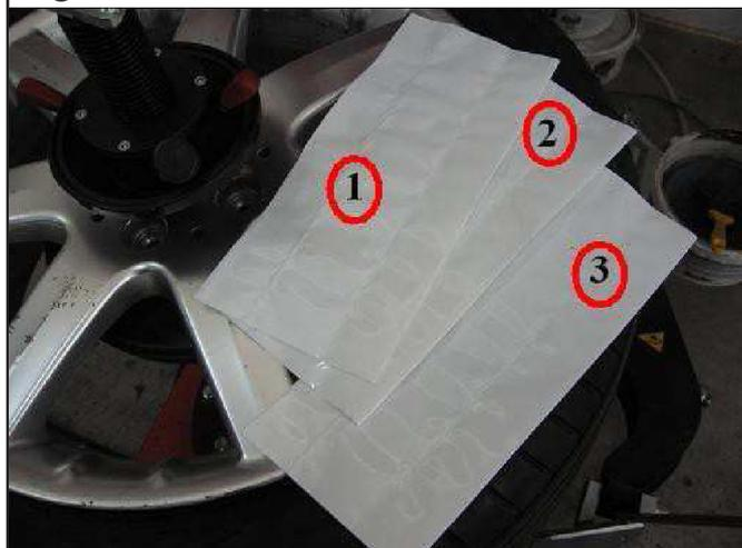
3. Unir tres láminas de protección talón (**Fig. 75**) y utilizar el destalonador para insertarlas entre la llanta y la cabeza útil (**Fig. 76 y Fig. 77**).
