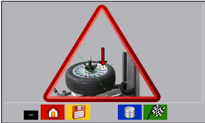
Ahora, el equipo está listo para un nuevo ciclo con la misma llanta y el mismo neumático. Remover la rueda instalada del mandril y montar la nueva rueda a desmontar. Bloquear la rueda y llevar la válvula en correspondencia del rodillo destalonador superior. Presionar dos veces el pedal de consentimiento (**Fig. 22 ref. C**) para iniciar un nuevo ciclo de desmontaje/montaje neumático.
