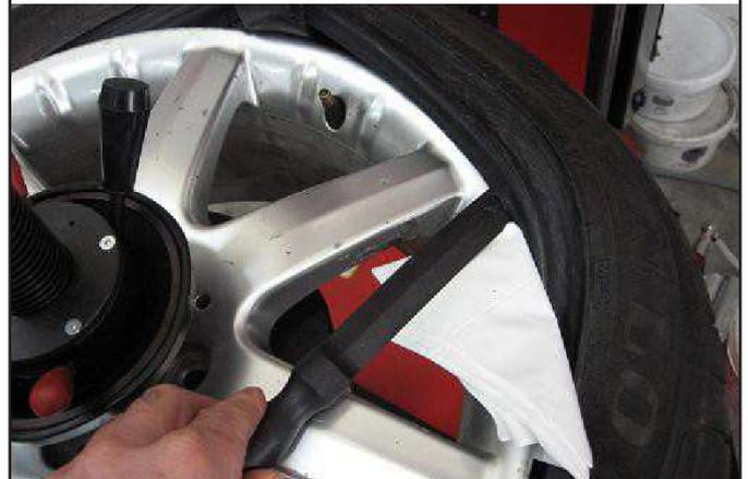
6. Levantar manualmente el talón inferior del neumático, empujarlo sobre el rodillo destalonador inferior y, mediante el botón correspondiente (**Fig. 17 ref. E**), levantar el propio rodillo.
