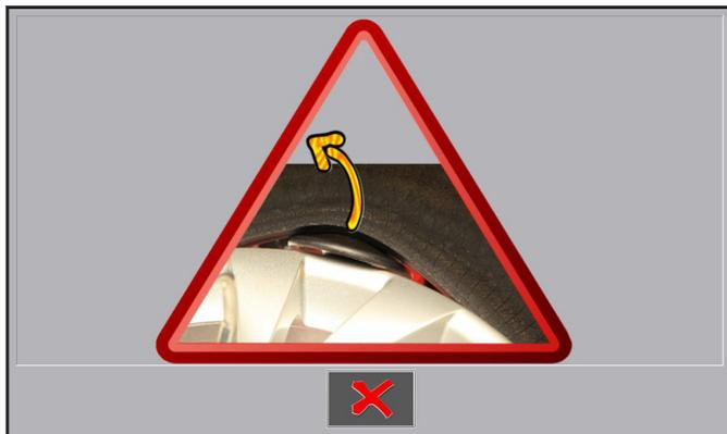
Al termine dell'operazione di smontaggio pneumatico comparirà a video il pulsante
