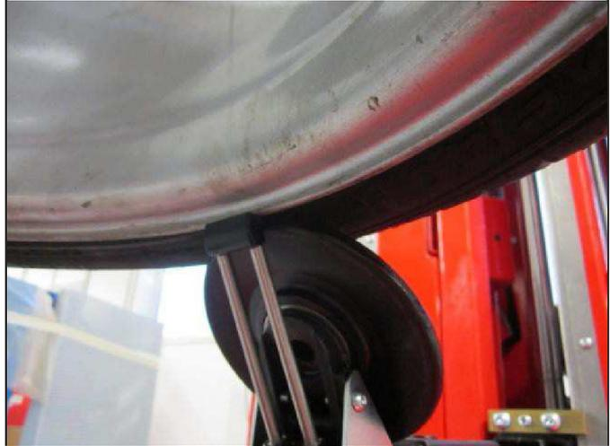
2. Posizionare la valvola in corrispondenza con il rullo stallonatore superiore ed iniziare il processo di stallonatura automatico (**Fig. 71**).
