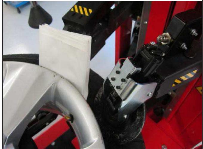
4. Premere il tallone nel canale del cerchio utilizzando il dispositivo premitallone (**Fig. 78**) ed inserire i cunei (**Fig. 79 e Fig. 80**).
