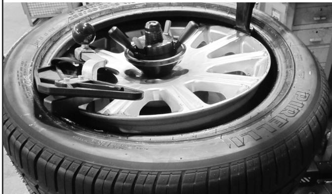
7. Abbassare il rullo stallonatore superiore in modo da mantenere il tallone dello pneumatico all'altezza del canale del cerchio (vedi **Fig. 59**).
