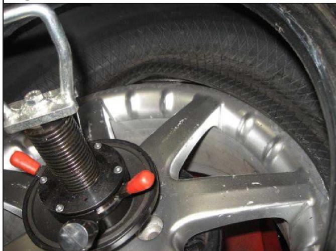
7. Premere il pedale di rotazione e ruotare la ruota fino a completa estrazione dello pneumatico.
