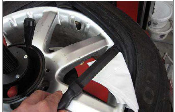
6. Sollevare manualmente il tallone inferiore dello pneumatico, spingerlo sul rullo stallonatore inferiore e, agendo sull'apposito pulsante (Fig. 17 rif. E), sollevare il rullo stesso.
