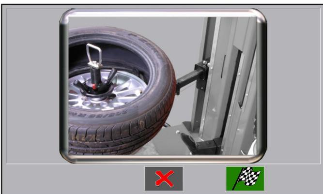
Al termine della fase precedente l'apparecchiatura posiziona la testa utensile superiore ed il rullo stallonatore superiore in posizione per il montaggio del tallone superiore.
