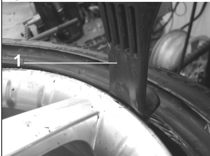
5. Quindi posizionare il tallone superiore sulla zona di montaggio della testa utensile (**Fig. 57 rif. 1**).
