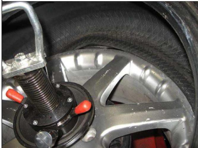
7. Appuyez sur la pédale de rotation et faites tourner la roue jusqu'à ce que le pneu soit complètement extrait.
