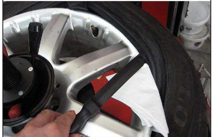
6. Soulevez manuellement le talon inférieur du pneu, poussez-le sur le rouleau décolle-pneu inférieur et, à l'aide du bouton approprié (**Fig. 17 réf. E**), soulevez le rouleau lui-même.
