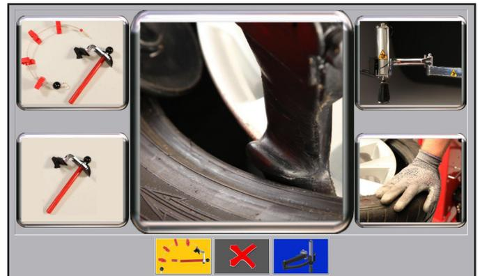
Avant d'assembler le talon inférieur, une fenêtre spéciale permet de choisir l'accessoire le plus adéquat pour poursuivre les opérations.
