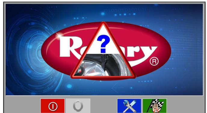
Dans la fenêtre principale s'affiche un triangle clignotant et le poussoir
