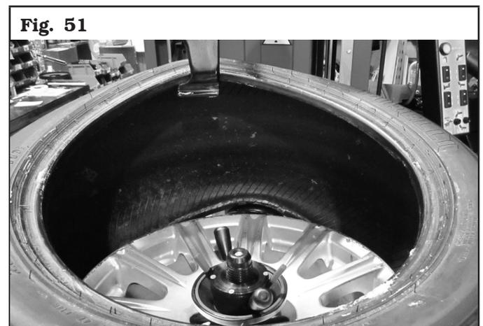
11. Faire avancer, donc, le rouleau décolle-pneus par la commande appropriée (**Fig. 17 réf. E**) pour le faire insérer entre le bord de la jante et le talon inférieur (voir **Fig. 52**).
