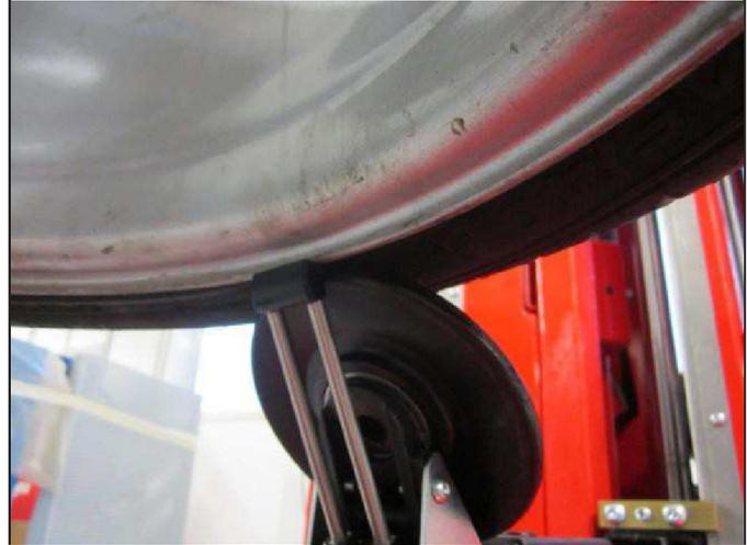
2. Positionner la soupape en correspondance avec le rouleau décolle-pneus supérieur et démarrer le processus de décolage automatique (**Fig. 71**).
