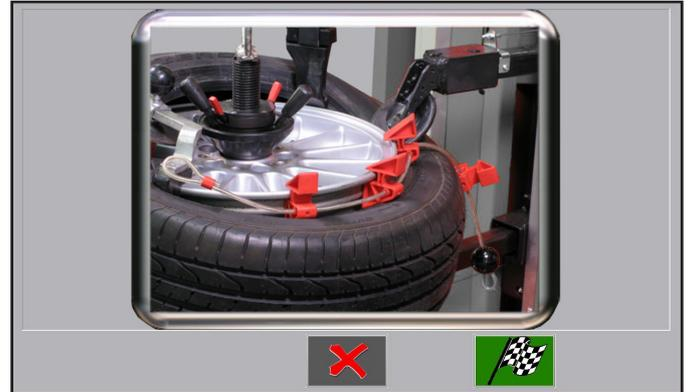
Choix des accessoires. Dans cette opération de montage, il est possible de choisir le type d'accessoires à utiliser pour terminer le montage.
