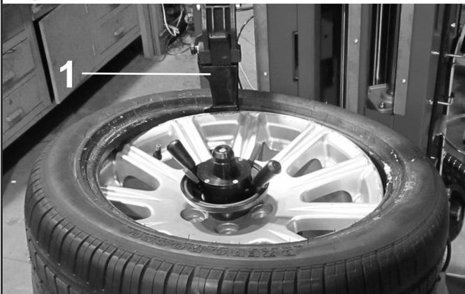
6. Monter le pousse-pneu avec guide voisin le bord de la jante (voir **Fig. 58**).
