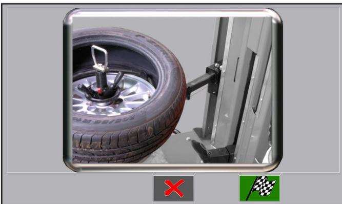
À la fin de l'opération précédente, l'équipement place la tête outil supérieure et le rouleau décolle-pneus supérieur pour le positionnement du montage du talon supérieur.
