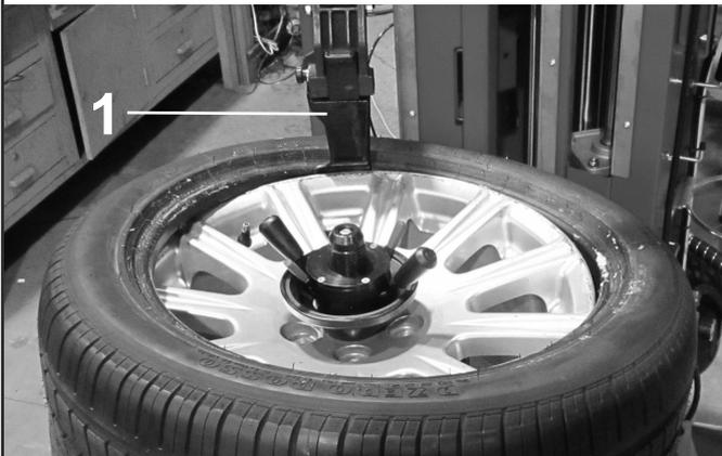
6. Montieren Sie den Wulstniederhalter mit Führung am Felgenreand (siehe **Abb. 58**).
