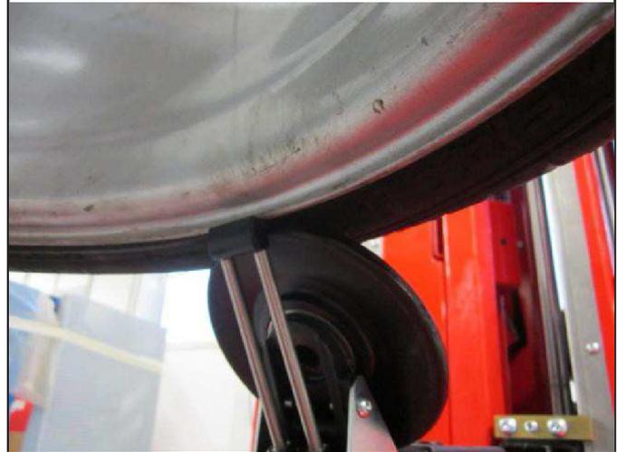
2. Positionieren Sie das Ventil in Übereinstimmung mit der oberen Abdrückerrolle und starten Sie den automatischen Abdrückervorgang (**Abb. 71**).
