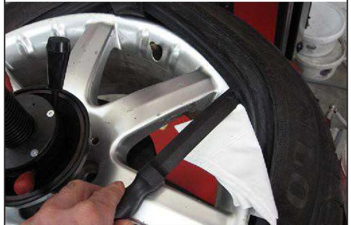
6. Heben Sie den unteren Wulst des Reifens manuell an, schieben Sie ihn auf die untere Abdrückerrolle und heben Sie die Rolle selbst mit der entsprechenden Taste (**Abb. 17 Pkt. E**) an.
