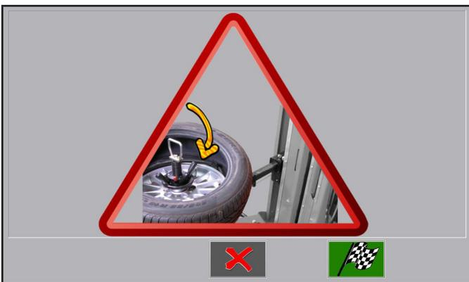
Durch zweimalige schnelle Betätigung und Gedrückt halten des Freigabepedals (**Abb. 22 Pkt. C**) wird die Montageoperation mit dem unteren Werkzeugkopf ausgeführt.
