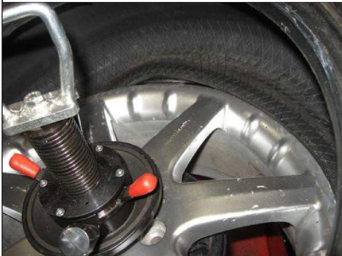
7. Drücken Sie das Drehpedal und drehen Sie das Rad, bis der Reifen vollständig herausgezogen ist.
