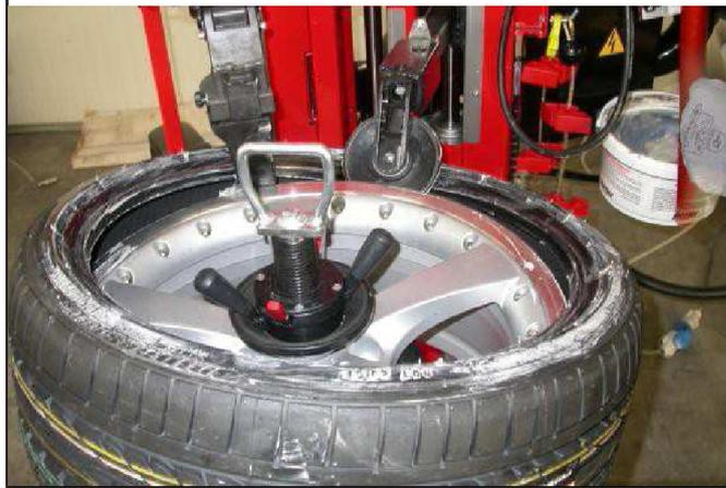
5. Positionieren Sie die Wulstabdrückerverlängerung und den den Wulstniederhalter mit Führung in Übereinstimmung mit dem Ventil/Sensor. Legen Sie die Wulstschutzhüllen (Abb. 92) auf das Felgenhorn und zu einem kleinen Teil auch unter die Wulstniederhalterverlängerung (Abb. 93), um eine Beschädigung des Wulstes zu vermeiden
