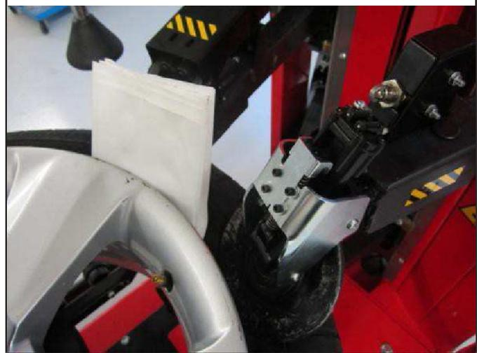
4. Drücken Sie den Wulst mit der Wulstabdrückvorrichtung (**Abb. 78**) in die Furche der Felge und setzen Sie die Keile (**Abb. 79 und Abb. 80**) ein.
