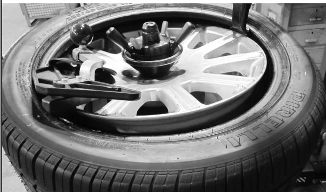
7. Die obere Abdrückrolle herunterlassen, so dass der Reifenwulst auf der Höhe der Felgenfurche gehalten wird (siehe **Abb. 59**).
