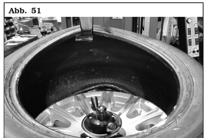
11. Anschließend die Abdrückrolle mit dem entsprechenden Befehl (**Abb. 17 Pkt. E**) nach vorne bewegen, so dass sie sich zwischen Felgenrand und unteren Wulst (siehe **Abb. 52**) schiebt.
