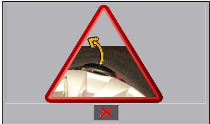
Am Ende der Demontageoperation des Reifens erscheint auf dem Bildschirm die Taste
