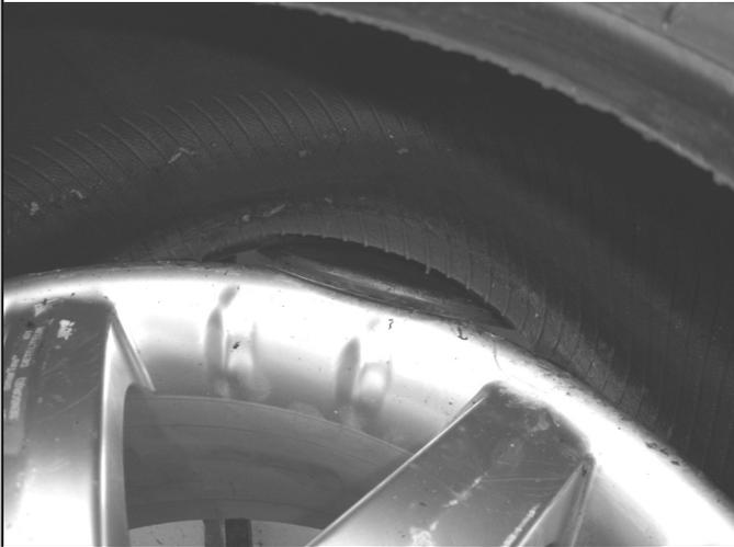
12. Anschließend drehen und den Wulst fertig ausbauen (siehe **Abb. 53**).
