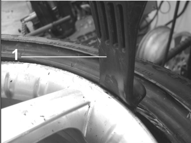
5. Anschließend den oberen Wulst an den Montagebereich des Werkzeugkopfes (**Abb. 57 Pkt. 1**) haken.
