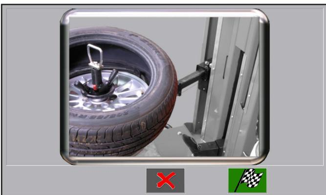
Am Ende der vorherigen Phase positioniert die Maschine den oberen Werkzeugkopf und die Abdrückrolle in die Position für die Montage des oberen Wulstes. Das Ventil positioniert zuerst den Einführungspunkt des Mitnehmers.
