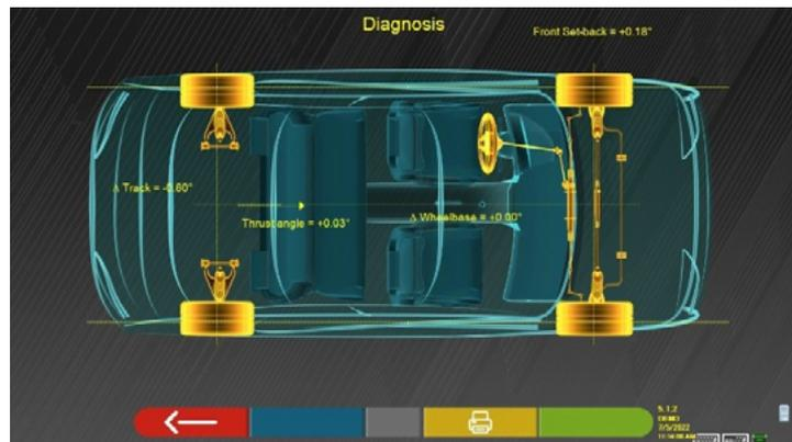
Esta medición se realiza durante la fase de alineación del vehículo (Pár. 7.9). In esta página se muestran las diferencias de distancia entre ejes y ancho de vía, así como el desplazamiento hacia atrás del eje delantero.
