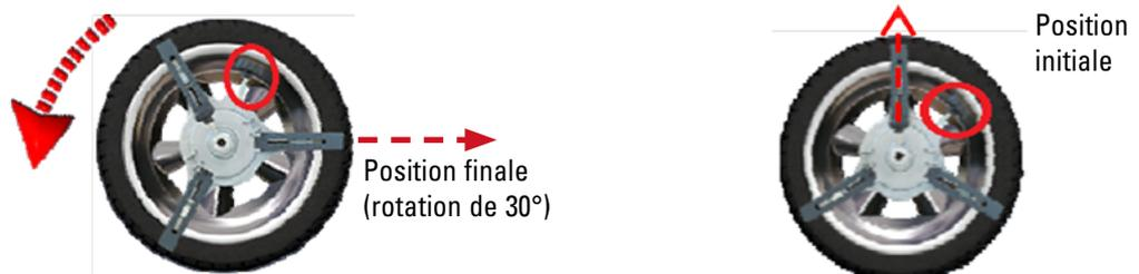
Appuyer sur la touche centrale sur une des têtes des capteurs au point d'arrivée.
