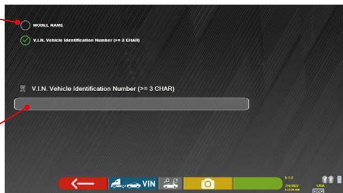
Le V.I.N. (Vehicle Identification Number) est un numéro de série unique utilisé par l'industrie automobile pour identifier les véhicules à moteur. Il consiste en une plaque alphanumérique de 17 caractères, généralement située à l'intérieur du compartiment moteur.
