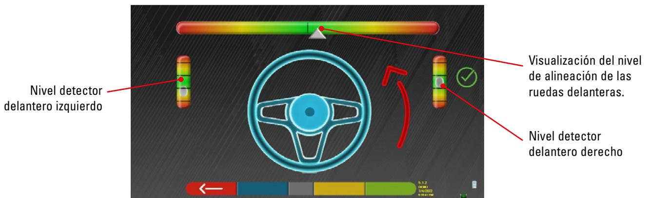
Realice el procedimiento de alineación y la posterior detección directa del ángulo:
