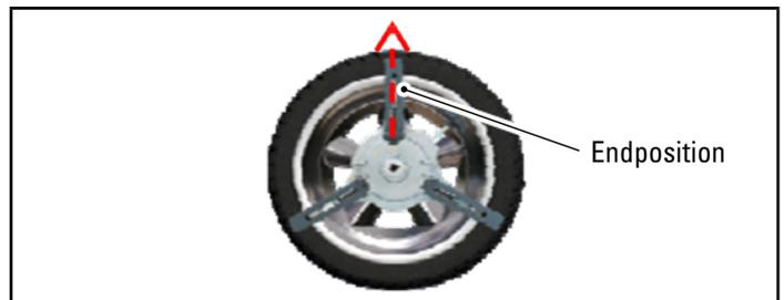
Bewegen Sie das Fahrzeug wieder vorwärts, bis der Pfeil des Fahrzeugs mit dem Zielpunkt übereinstimmt (kehren Sie in die Ausgangsposition in der Mitte der Teller zurück). Der „STOPP“ wird einige Sekunden lang angezeigt. Die Maße werden erfasst. Das Verfahren der Rundlaufkorrektur mittels Schieben wurde ausgeführt.
