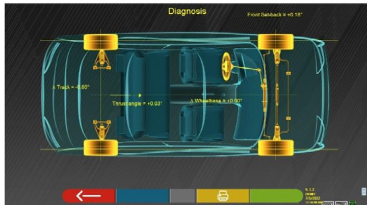
Questa misurazione viene eseguita durante la fase di allineamento del veicolo (Par. 7.9). In questa pagina vengono visualizzate le differenze di interasse e carreggiata e l'arretramento dell'asse anteriore.
