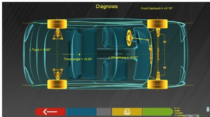
Diese Messung wird während der Fahrzeugausrichtungsphase durchgeführt (Abs. 7.9). Auf dieser Seite werden die Unterschiede im Radstand, in der Spurweite sowie der Versatz der Vorderachse angezeigt.
