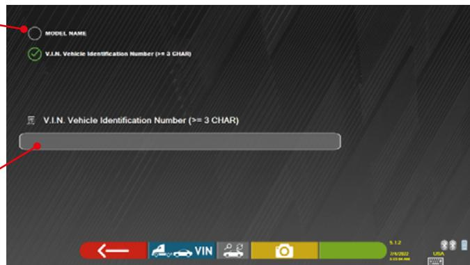
Il V.I.N. (Vehicle Identification Number) è un numero di serie unico usato dall'industria automobilistica per identificare i veicoli a motore, consiste di una targhetta con 17 caratteri alfanumerici situati di solito all'interno del vano motore.
