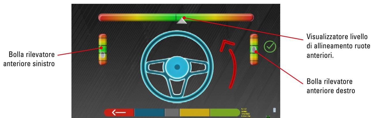
Visualizzatore livello di allineamento ruote anteriori.
