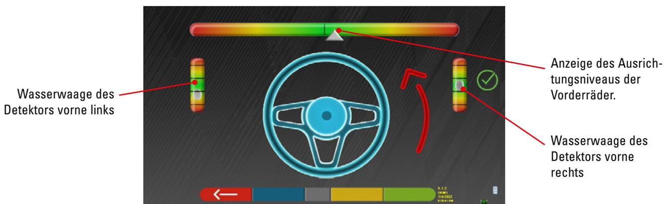
Führen Sie den Ausrichtungsvorgang und die anschließende Erkennung der direkten Winkel durch:
