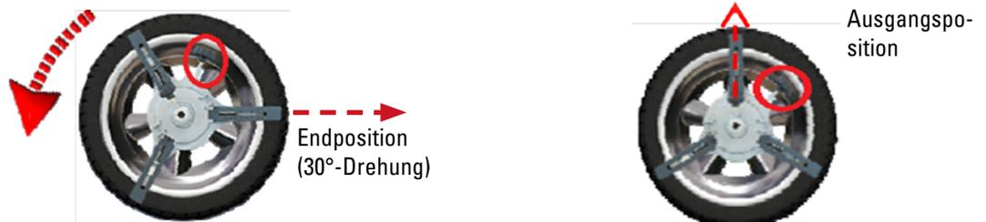
Drücken Sie die mittlere Taste an einem der Sensorköpfe am Endpunkt.
