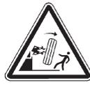
**ASSICURARSI CHE LA PRESA DELLA RUOTA SIA SICURA ONDE EVITARE LA CADUTA DELLA STESSA DURANTE LE OPERAZIONI DI SMONTAGGIO. PER RUOTE PESANTI E/O DI NOTEVOLI DIMENSIONI UTILIZZARE UN MEZZO DI SOLLEVAMENTO ADEGUATO.**
