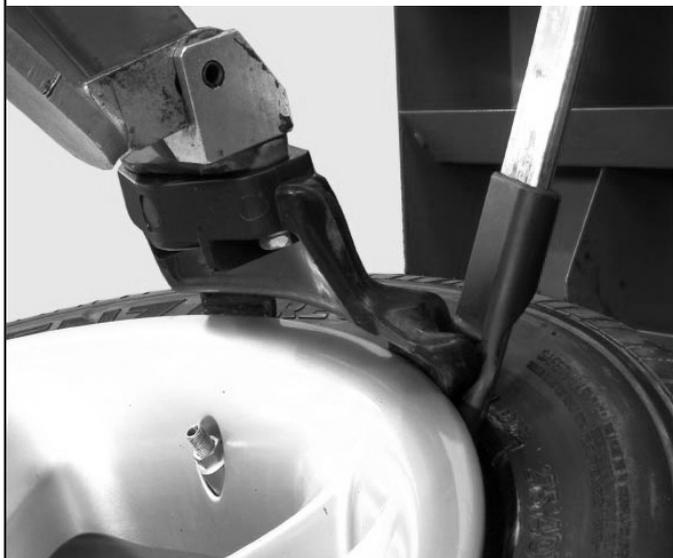
2. ...tirer le levier du dispositif vers le bas, jusqu'à ce que la tête outil entre en contact avec le bord de la jante ;
