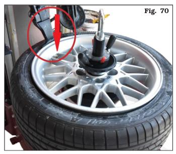
2. Commencer à tourner la roue (sans s'arrêter jusqu'à ce que la tête outil soit insérée). Lorsque la soupape est vers 3 heures (Fig. 71), appuyez sur le poussoir de descente de la tête outil (Fig. 63 réf. C) et insérezla dans le pneu (Fig. 72).
