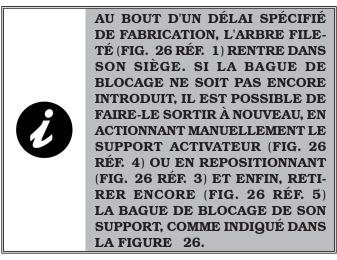
introduire et bloquer la bague de blocage (Fig. 26 réf. 2) sur l'arbre fileté (Fig. 26 réf. 1) comme décrit en suite ;
