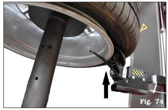
5. Finir de soulever la tête outil, positionner le dispositif pousse-talon rotatif vers 6 heures sur le pneu (**Fig. 75**).
