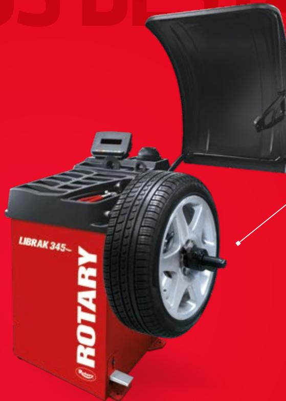
Doble luz LED y raya láser (con línea a las 6 en punto para contrapesos adhesivos) para facilitar la correcta colocación del contrapeso.
