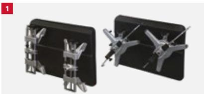
**1** Disponible con 2 pares de garras de 4 puntos STDA33EU o de tres puntos STDA35E. El modelo equipado con garras de 3 puntos (STDA35E) permite omitir el procedimiento de compensación del alabeo, agilizando el trabajo del operario y maximizando la eficiencia del taller.
