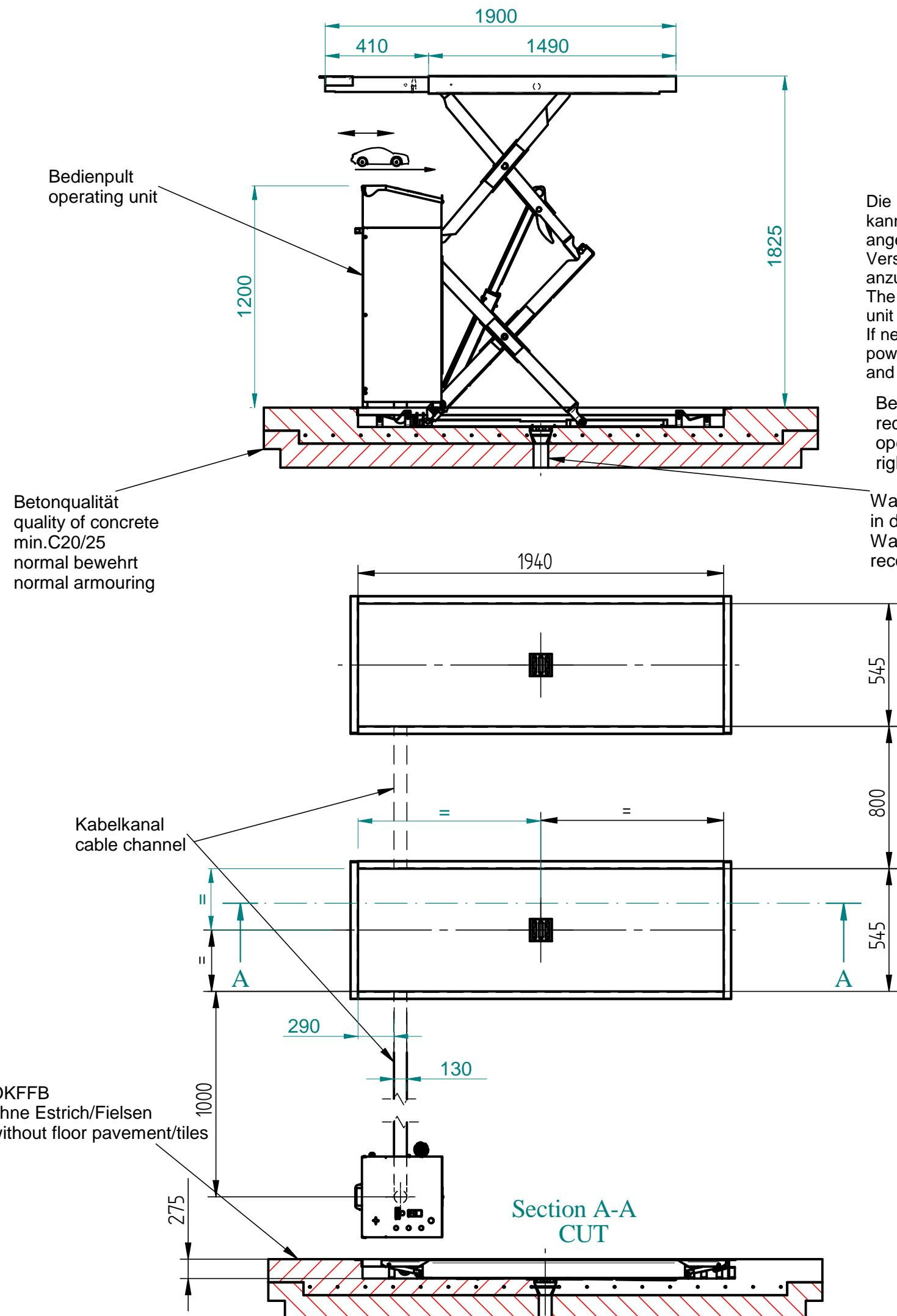
Die Position des Bedienpults kann den örtlichen Gegebenheiten angepasst werden. Ggf. sind die Versorgungsleitungen, Leerrohre anzupassen.
