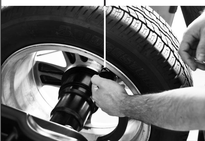
À la fin de la procédure, il est possible de vérifier les conditions d'équilibrage de la roue en effectuant un ultérieur lancement de contrôle.
