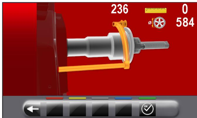
Positionner la tige (**Fig. 68 réf. 1**) sur le plateau du mandrin (**Fig. 68 réf. 2**).
