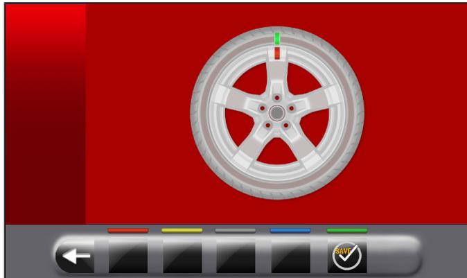
**ÉTAPE 1.** Porter la flèche présente sur le flasque "à midi". Faire un signe de référence, à l'aide d'une craie par exemple, sur la jante et le pneu à la hauteur de la flèche présente sur le plateau, de façon à remonter la jante dans la même position sur la machine.
