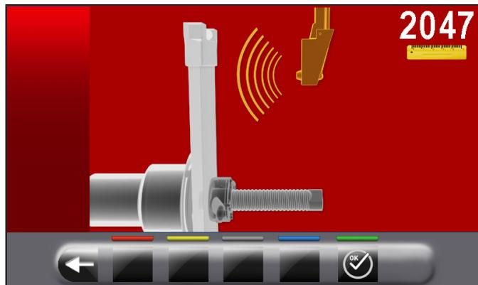
Fermer le couvre-roue jusqu'à porter le senseur mesure largeur automatique en face du corps régleur installé précédemment.
