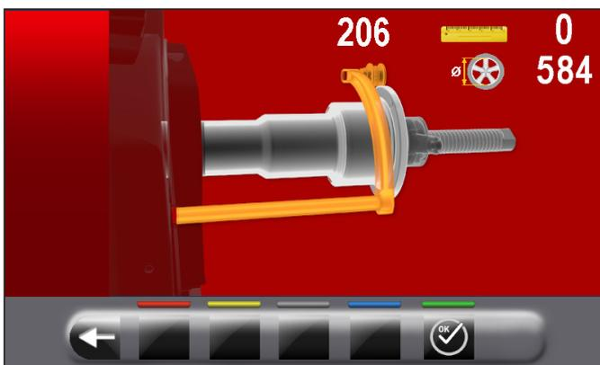
Positionner la tige (Fig. 45 réf. 1) sur le plateau du mandrin (Fig. 45 réf. 2).
