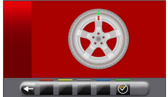
**ÉTAPE 1.** Porter la flèche présente sur le flasque "à midi". Faire un signe de référence, à l'aide d'une craie par exemple, sur la jante et le pneu à la hauteur de la flèche présente sur le plateau, de façon à remonter la jante dans la même position sur la machine.
