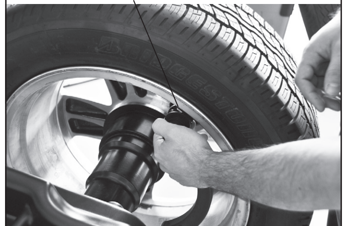
Appliquer le poids dans la position où la pince du poids touche la roue
