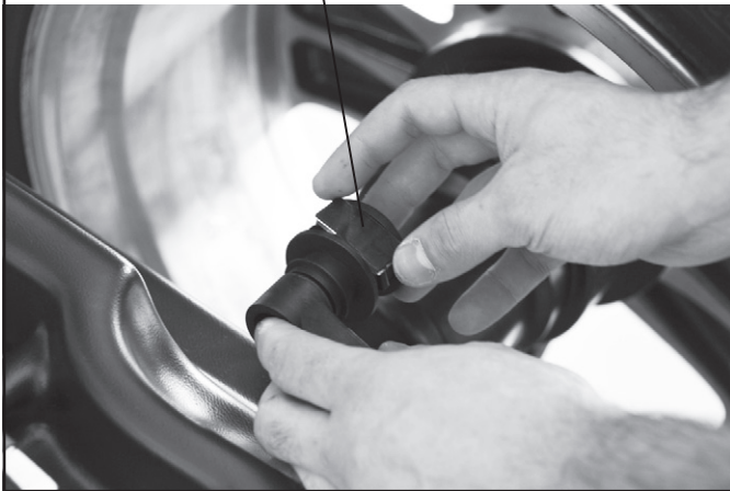
Fig. 45 Introduire le poids adhésif dans la pince de la tige de la pince
