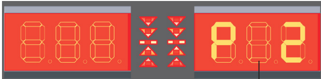
Fig. 60 A la fin des opérations ÉTAPE 2 appuyer sur la touche R/C pour valider
