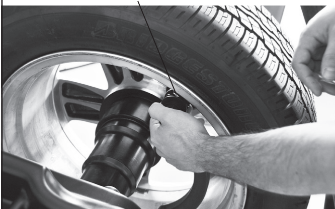
Appliquer le poids dans la position où la pince du poids touche la roue Fig. 46
