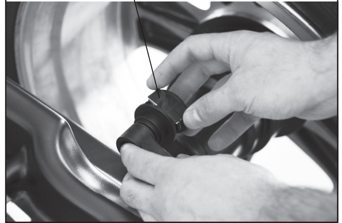
Fig. 38 Introduire le poids adhésif dans la pince de la tige de la pige
