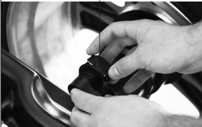
Fig. 32 Introduire le poids adhésif dans la pince de la tîge de la pîge
