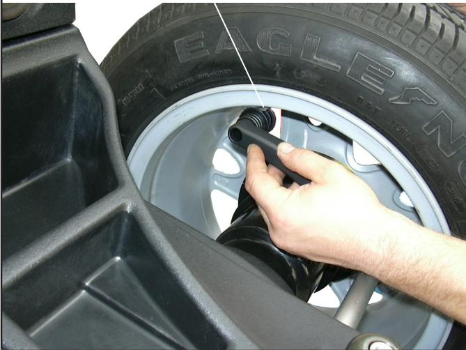
Al finalizar el procedimiento es posible controlar las condiciones de equilibrado de la rueda, realizando un ulterior balanceo de control.
