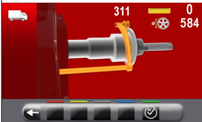
Posicionar el palpador (Fig. 124 ref. 1) en la brida del mandril (Fig. 124 ref. 2).
