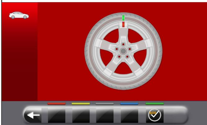
**PASO 1.** Lleve la flecha de la brida a las 12. Marque una marca de referencia, por ejemplo con un trozo de tiza, en la llanta y en el neumático en correspondencia con la flecha en la brida, para que la llanta se pueda volver a montar en la misma posición en el equipo.
