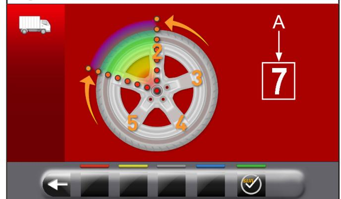
Llevar a las 12 el segundo radio. El equipo calculará automáticamente el número de los radios totales. Si el valor indicado en la pantalla (A) es correcto apretar
