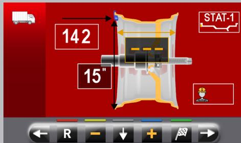
**ESTE CASO OCURRE SÓLO SI DE LA PÁGINA "HOME" SE DETECTA UNA SOLA MEDIDA INTERIOR LLANTA. EL PROGRAMA SE CONFIGURA AUTOMÁTICAMENTE A "ESTÁTICO" PERO PERMITE (EN CASO DE FALTA DEL PALPADOR DE ANCHURA) INTRODUCIR MANUALMENTE EL ANCHURA LLANTA Y PASAR RÁPIDAMENTE AL PROGRAMA "DINÁMICO".**
