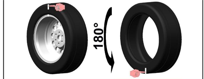
Montar nuevamente la rueda en la equilibradora colocando la señal de referencia de la llanta en correspondencia de la flecha en la brida.
