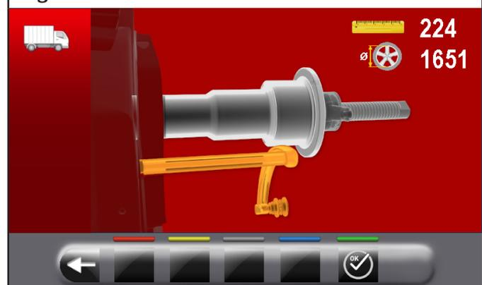
Posicionar el palpador como indicado en la figura ilustrada después:
