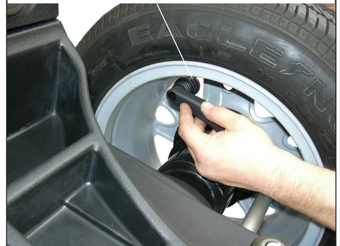
4. llevar el brazo del calibre distancia-diámetro en posición de reposo, después de haberlo llevado hacia el mandril para desbloquearlo de la posición de aplicación peso;
