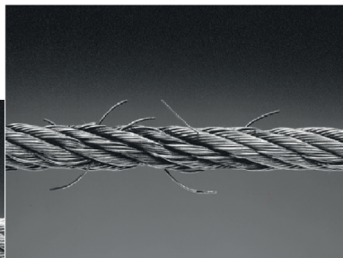
Unzulässiges Stahlseil - stark ausgefranst
