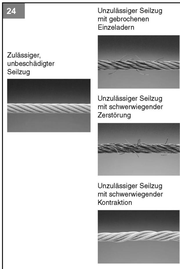
**i** Seilzüge reißen meist dann, wenn sie eine der gezeigten Beschädigungen aufweisen. Dies sind insbesondere beschädigte, zerstörte, übermäßig gestreckte oder deformierte Seilzüge mit teilweise unterschiedlichen Durchmessern.
