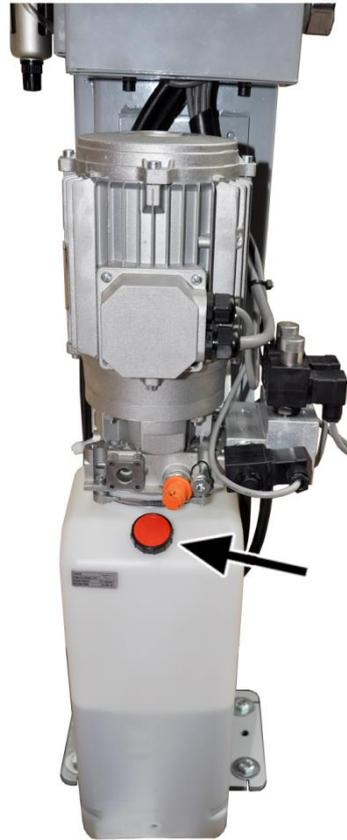
3. Hydrauliktank ordnungsgemäß einbauen.
