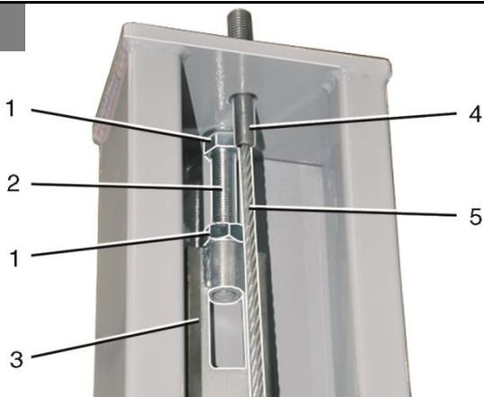
11. Mit den Einstellmutter (1) alle 4 Klinkenschienen so einstellen, dass die beiden Fahrflächen
