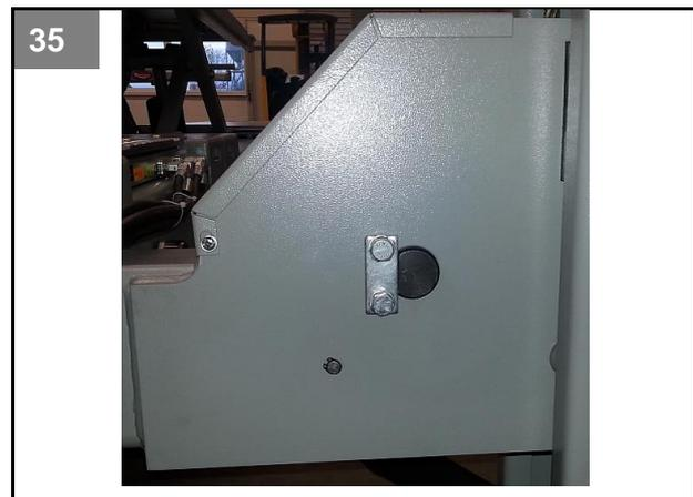
3. Jeweils die beiden Schrauben und die Verdrehsicherung entfernen
