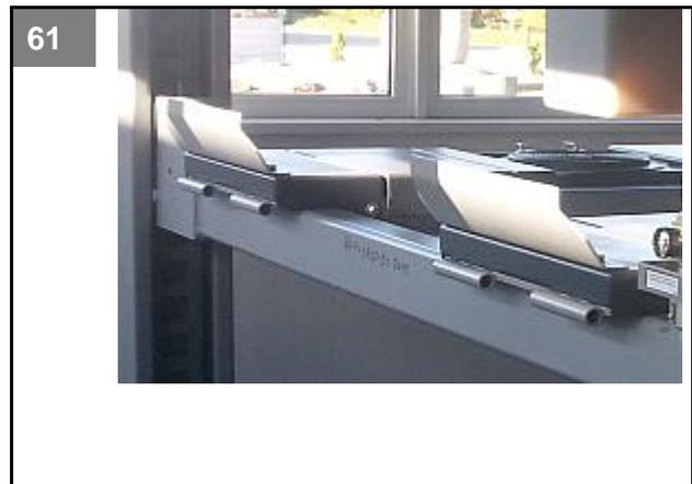
6. Das mittlere fixierte Füllblech mit den seitlichen Befestigungen montieren. Bei der LT-Version ein kurzes Füllblech vor dem Radfreiheber.
