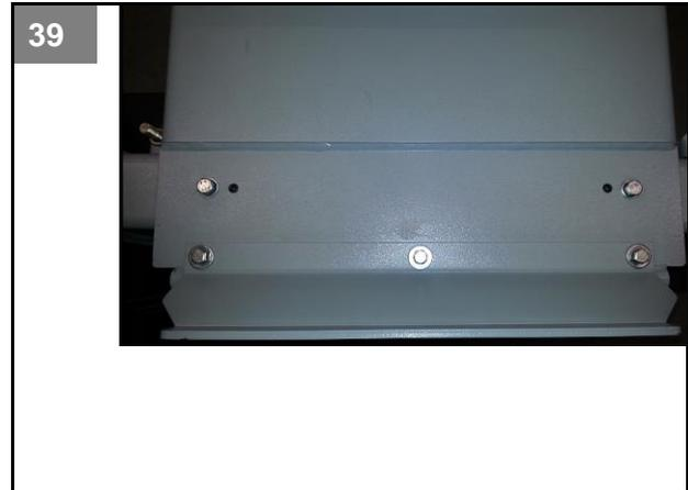
1. Fahrschienen vorne und hinten auf die Befestigungslöcher der Querträger ausrichten. Dabei auf korrekte Lage der Seilzüge und Leitungen achten. Seile dürfen nicht aus den Rillen der Seilrollen fallen.
