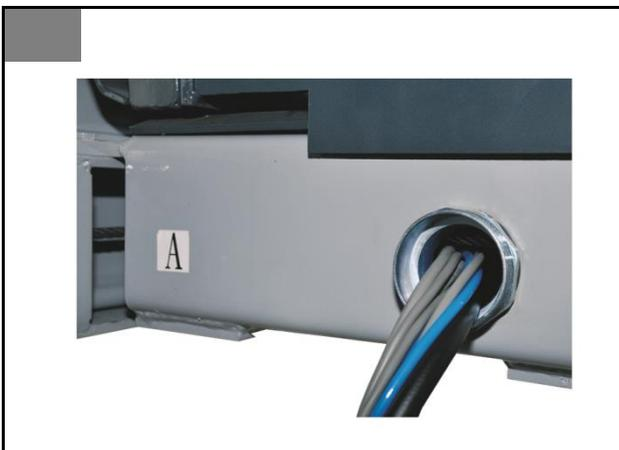
5. Verschraubung (Metallschutz) für flexiblen Schlauch von innen und außen in die feststehende Fahrschiene einsetzen und fest anziehen.
