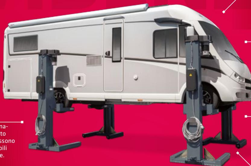
Le rotelle dei carrelli sollevatori sono dotate di cuscinetti autolubrificanti che non necessitano manutenzione.
