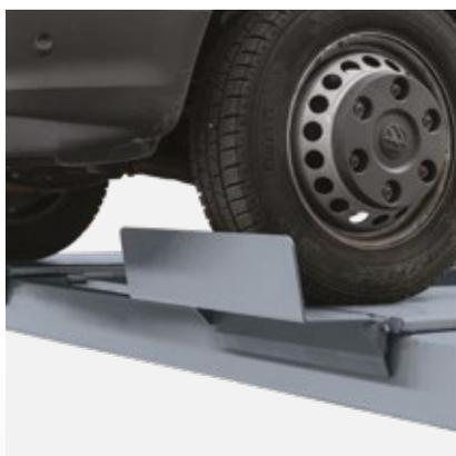
1 4-стоечный подъемник оснащен пневматически разблокируемым устройством опускания (через каждые 100 мм). Таким способом облегчается работа тросов и гидравлической системы. Благодаря настраиваемым трещоточным полосам на стойках подъемника, его можно выровнять абсолютно точно по горизонтали.
