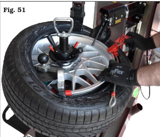
8. Utilizzando la dimensione corretta in base al tipo di cerchio (EH, EH2), inserire il primo cuneo, e premendo lentamente il pedale di rotazione, inserire in sequenza tutti gli altri. Continuare lentamente la rotazione fino al completo montaggio dello pneumatico (**Fig. 52**)
