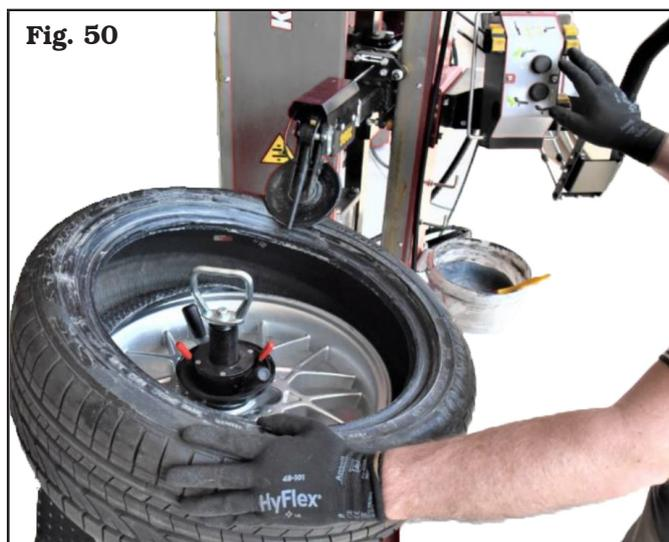
4. Premendo il pedale di rotazione, posizionare la valvola circa a ore 3, agendo sull'apposito pulsante (**Fig. 8 rif. C**), posizionare l'utensile di montaggio sul bordo del cerchio.
