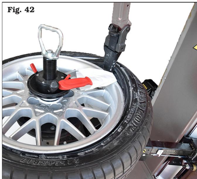
9. Bloccare con la mano l'utensile di protezione (**Fig. 43**). Premendo il pedale di rotazione smontare il primo tallone dello pneumatico.
