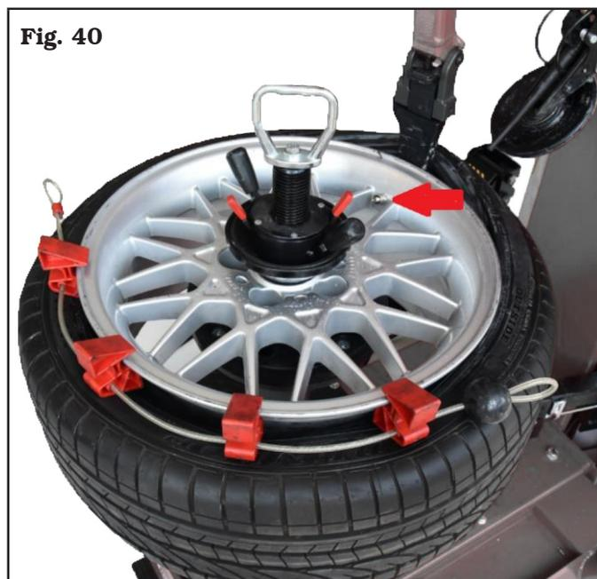
7. Appuyer sur le bouton de montée du bras décolle-pneus inférieur (**Fig. 8 réf. B**) jusqu'à ce que le disque décolle-pneus repose sur le pneu. Appuyez légèrement pour réduire la tension sur le talon opposé du pneu et maintenez-le en place (**Fig. 41**).
