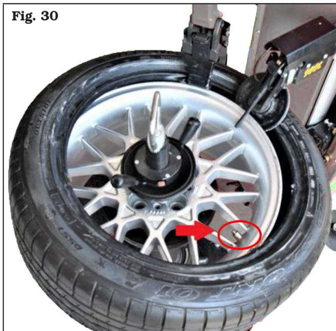
6. Insérez le dispositif pousse-talon exactement en correspondance avec la valve (**Fig. 31**). Monter la protection en plastique sur le bord de la jante en correspondance avec le pousse-talon comme indiqué sur la **Fig. 32**.
