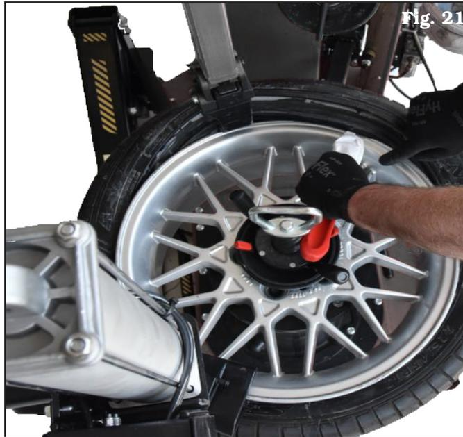
7. Appuyez sur le bouton approprié (**Fig. 8 réf. C**). Soulevez l'outil d'extraction et éloignez-le du pneu.
