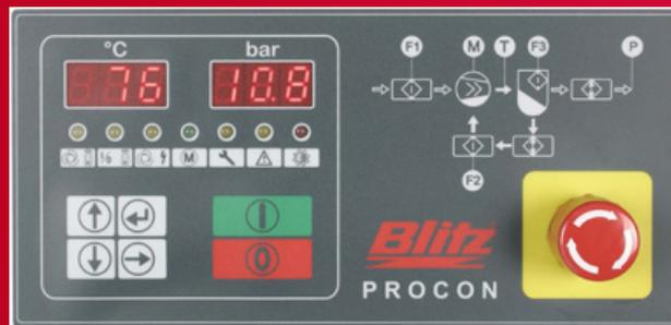
Un sistema diagnostico integrato monitora tutti i parametri operativi rilevanti per la sicurezza.
