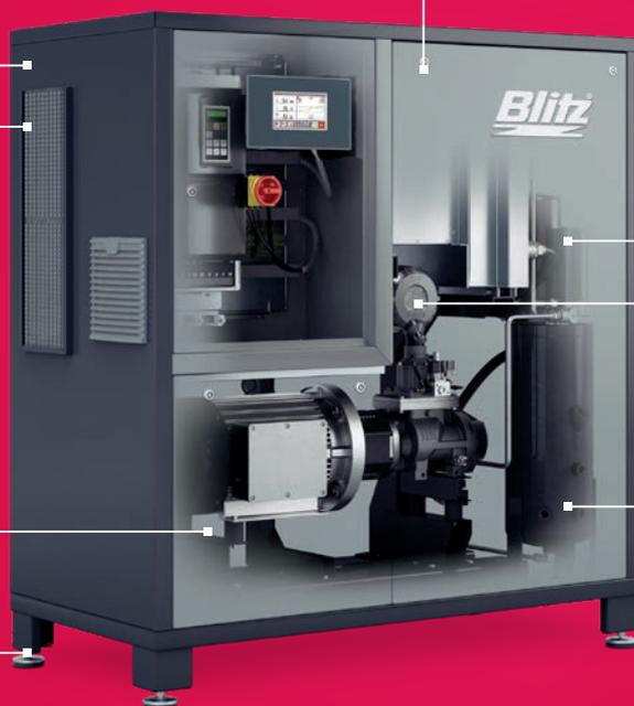
Séparation d'huile en plusieurs phases - La séparation gravitationnelle verticale par séparateur cyclonique garantit des pertes de pression minimales avec la plus faible teneur en huile résiduelle.
