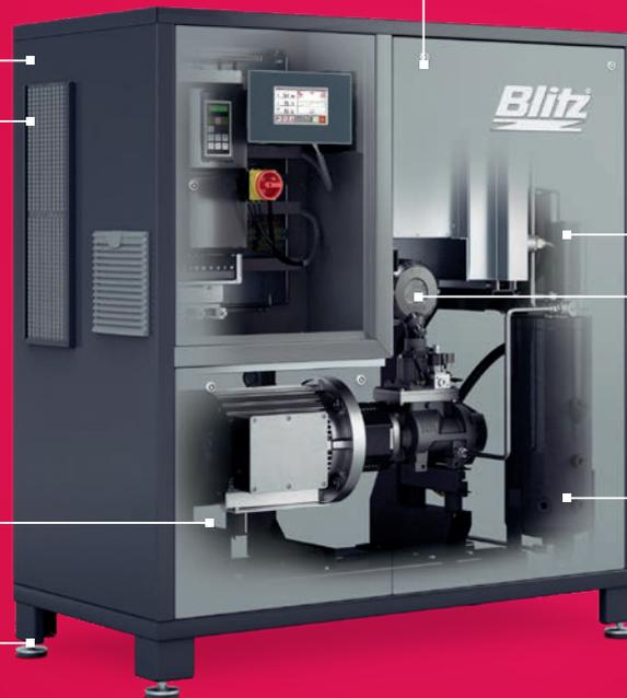
Mehrstufige Ölabscheidung – Die vertikale Schwerkraftabscheidung als Zyklonabscheider sichert minimale Druckverluste bei niedrigstem Restölgehalt.
