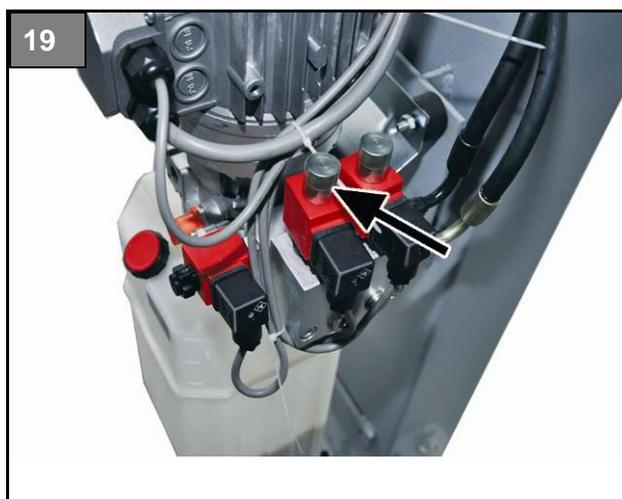
3. Снимите клапан с резьбового стержня и закрутите металлический колпачок полностью (Экстренный ручной режим = активен).
