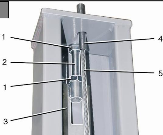
10. С помощью регулировочных гаек (1) настройте все 4 фиксирующие планки, чтобы выровнять две въездные поверхности с
