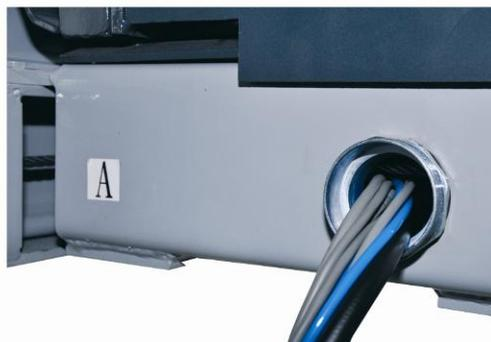
5. Вставьте крепеж (металлическая направляющая) для гибких шлангов внутрь и изнутри фиксированного желоба, затем затяните.
