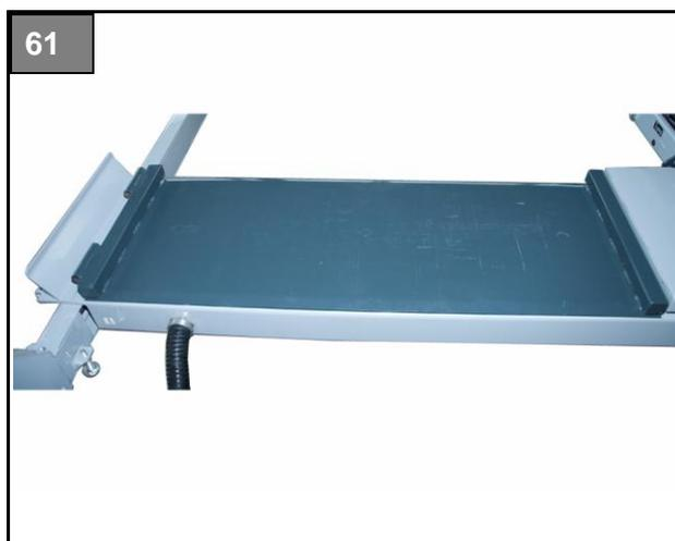
6. Inserire la piastra di riempimento in modo tale che tutti i bulloni sporgano dalla parte inferiore della pista.
