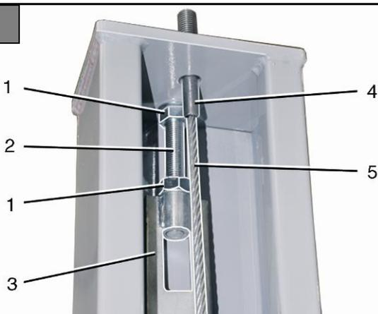
10. Utilizzando i dadi di regolazione (1) regolare tutti le 4 barre di fermo in modo che le due superfici di guida siano allineate con una tolleranza di al-
